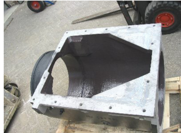
上圖：顯示零件內部使用 UPS240 及 UPS205 修復後的狀況。
