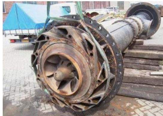
葉輪部份遭受嚴重的砂水沖磨所造成的損傷
