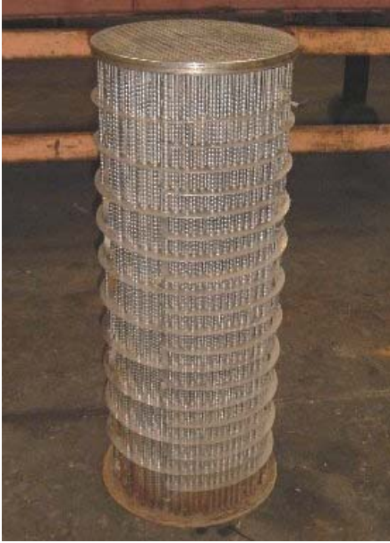
熱交換器內部
